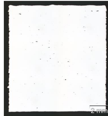
Dichtewürfel mit Restporosität (Pulverbettverfahren)
